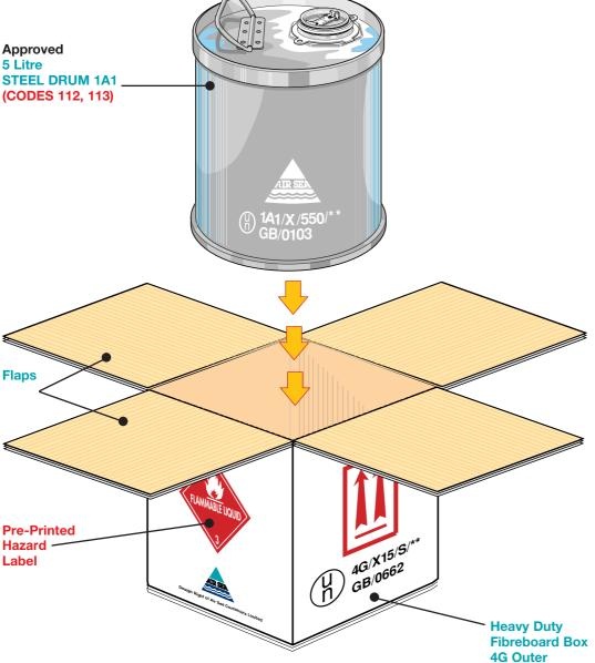
**ASSEMBLY DETAILS: FIBREBOARD BOX: 4G OUTER** DE:
