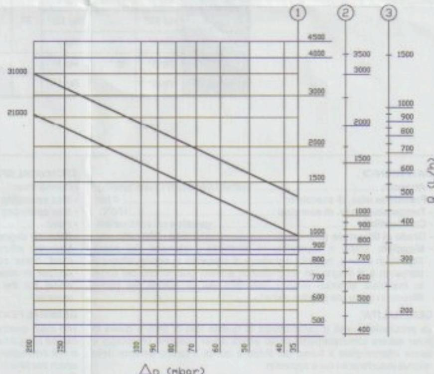
La portata della scala n° 1 relativa alla viscosità 1,5°E (gasolio), è stata ricavata utilizzando pacchi filtranti da 0,1 mm.
