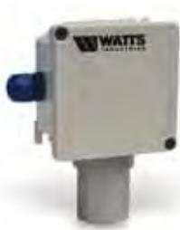
Rivelatore di gas in custodia metallica (modo di protezione gruppo II, categoria 3G, Ex nA IIC T6) con led di indicazione stato funzionale, per la segnalazione di allarmi gas tramite uscita analogica 4 ÷ 20 mA o su soglie di intervento (preallarme, allarmi livello 1 e 2, guasto) liberamente impostabili tramite dip-switch.
