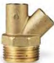
Raccordo doppio angolare per serbatoi, completo di sacchetto raccordi per collegamento tubi Ø 6 x 8, 8 x 10, 10 x 12 mm. Corpo in ottone CW617N. Attacco serbatoio 1" M. Attacco aspirazione e ritorno 3/8" F.
