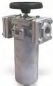
Filtro autopulente alta pressione per gasolio, olio combustibile. Attacchi 1.1/2" x 1.1/2", Pmax 15 bar. Attacchi flangiati con controflange filettate UNI-ISO 7/1 a corredo.
