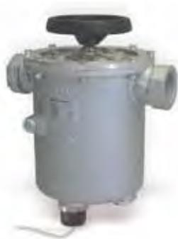
Filtro autopulente riscaldato per gasolio, olio combustibile. Attacchi 2" x 2", P. max 4 bar.
