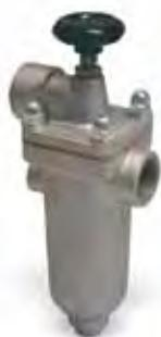
Filtro autopulente per gasolio, olio combustibile. attacchi 1" x 1", Pressione max. 4 bar.
