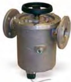
Filtro autopulente riscaldato per gasolio, olio combustibile. Attacchi DN 50, P. max 4 bar.
