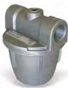
Filtro di linea per gasolio, olio combustibile, aria. Attacchi 3/8", vaschetta alluminio.
